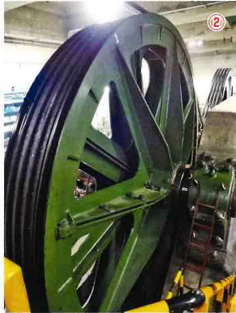
※ケーブル(鋼索)は従索輪から ③案内索輪の向こう(写真左奥) へと延び、車両と繋がっています。
