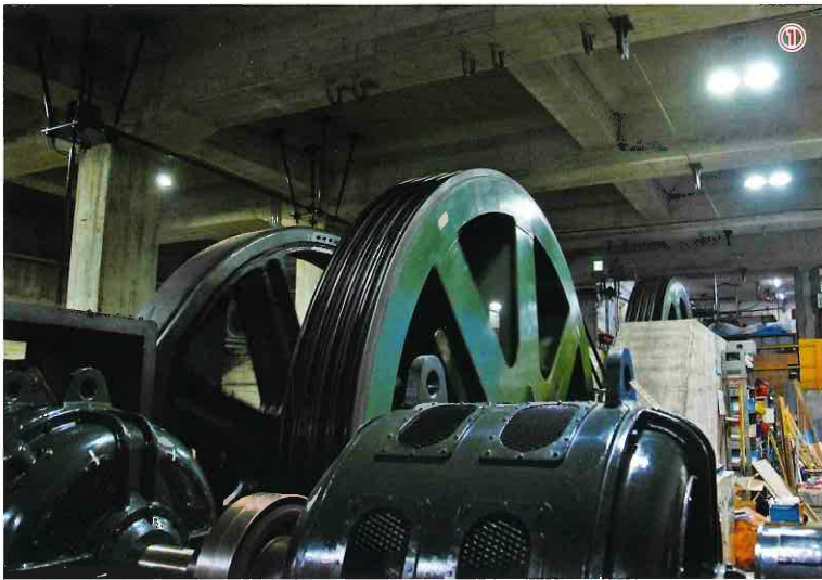
※ケーブル(鋼索)は従索輪から ③案内索輪の向こう(写真左奥) へと延び、車両と繋がっています。
